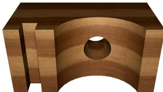
Dans cet exemple on soustrait d'un parallélépipède un contour extrudé comportant une courbe de Bézier. Un cylindre est ensuite utilisé pour percer le résultat.
